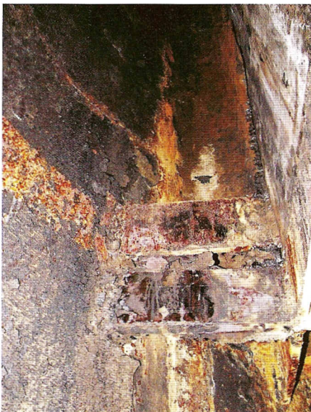
Fig. 6: Encrustations of sugar charcoal in an internal rising duct Abb. 6: Anbackungen von Zuckerkohle im innen liegendem Steigkanal
