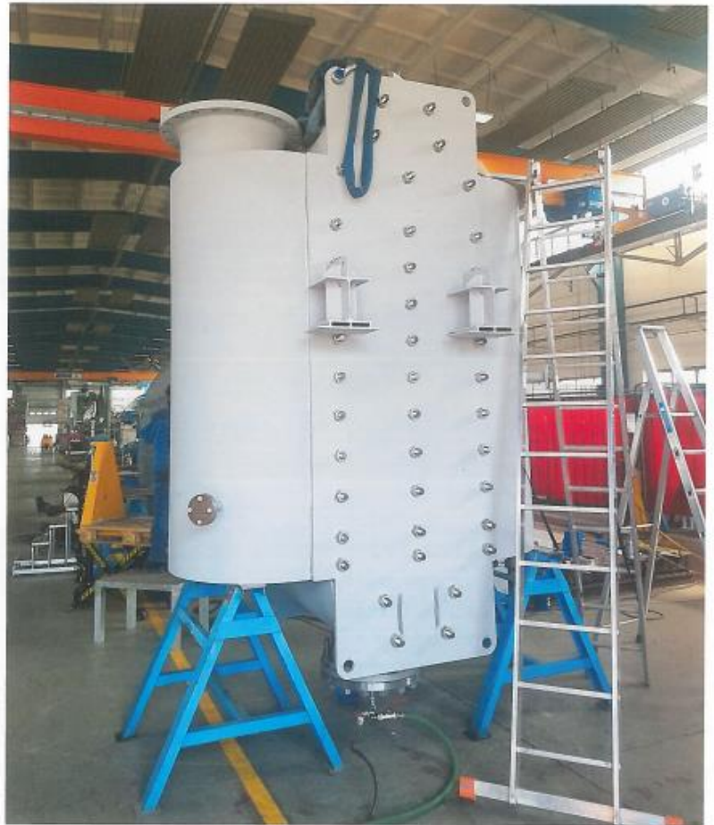
Bild 4. Vorbereitung eines Heizkondensators zur Druckprobe
